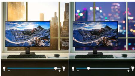
LightSensor utiliza un sensor inteligente para ajustar el brillo de la imagen en función de las condiciones de iluminación de la habitación,
