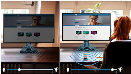
PowerSensor es un 'sensor de personas' incorporado que transmite y recibe señales infrarrojas inofensivas para determinar si el usuario está presente y reduce automáticamente el brillo del monitor cuando se ausenta, reduciendo el gasto energético hasta un 70 % y prolongando la vida del monitor.
