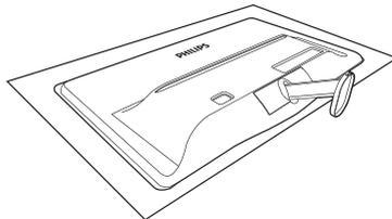
2. Sujete el soporte de la base del monitor con ambas manos e inserte firmemente el soporte de la base en la columna de la misma.
