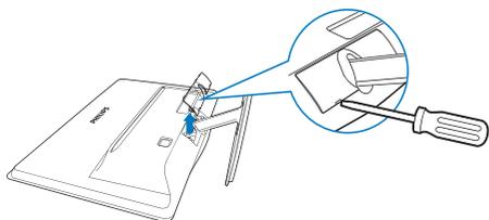
2. Retire los 4 tornillos y, a continuación, la base del monitor:
