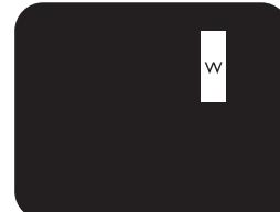
Tri susedna osvetljeni sub-piksela (jedan beli piksel).
