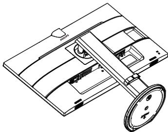
3. Нажав кнопку фиксатора, наклоните основание и извлеките его.
