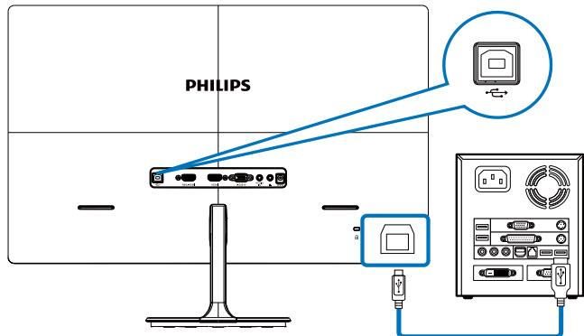
1. Sambungkan kabel USB ke upstream hub USB di IO bagian samping monitor dari PC.
