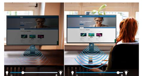
PowerSensor è un sensore integrato che rileva la presenza delle persone. Trasmette e riceve segnali infrarossi non nocivi per determinare l'eventuale presenza di un utente. Se l'utente si allontana dalla scrivania il sensore riduce automaticamente la luminosità dello schermo, riducendo i costi energetici fino al 70% e prolungando la durata di utilizzo dell'apparecchio.
