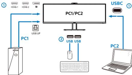
3. 进入OSD菜单。进入KVM层，通过选择“自动”“USB C”或“USB up”将外设的控制从一台设备切换到另一台设备。重复此步骤即可通过使用一组外设来切换控制系统。
