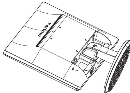
2. 壓下鎖定夾可分離底座支架與底座安裝座。
