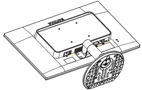
2. Utilice un destornillador plano para quitar los cuatro elementos Mylar de la tapa de la bisagra.
