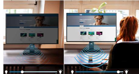
PowerSensor je vgrajeni senzor, ki zaznava prisotnost uporabnika. Oddaja in sprejema neškodljive infrardeče signale, na osnovi katerih ugroti, ali je uporabnik za računalnikom ali ne. Če uporabnik zapusti delovno mizo, senzor samodejno zmanjša svetlost zaslona, s čimer prihrani do 70 % energije in podaljša življenjsko dobo monitorja.
