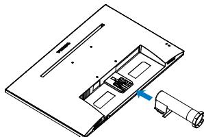
2. 請用雙手緊握顯示器底座支架，並將底座支架確實裝入底座安裝座中。
