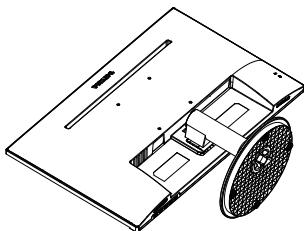
2. 壓下鎖定夾可分離底座支架與底座安裝座。
