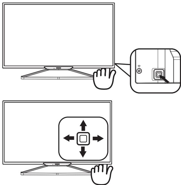
要访问 OSD 菜单，请使用显示器背面的开关按钮。像操纵杆一样操作此按钮。要移动光标只需在四个方向切换按钮。按下这个按钮选择所需的选项。
