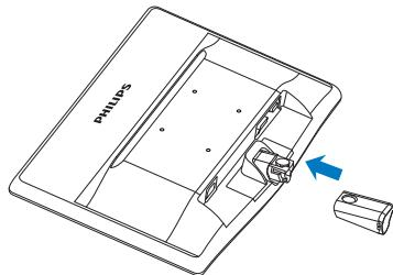
3. 用双手拿住显示器底座支撑臂，用力将底座支撑臂插入底座支撑柱。
