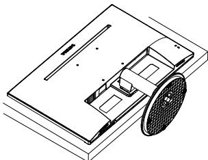
2. 按锁定夹，从底座支撑柱上卸下底座支撑臂。
