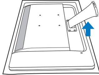
2. Sujete la base del monitor con ambas manos e inserte firmemente la base en la columna de la misma.
