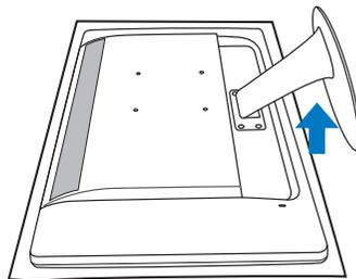
2. Presione las pestañas de bloqueo para separar el soporte de la base de la columna de la base.
