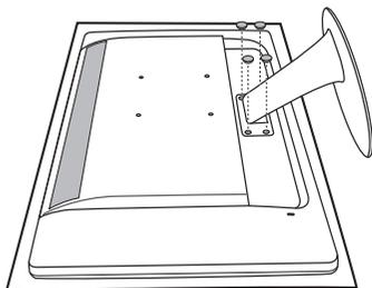
2. Quite los 4 tornillos y después retire la base del monitor:
