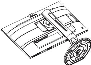
3. Нажав кнопку фиксатора, наклоните основание и извлеките его.
