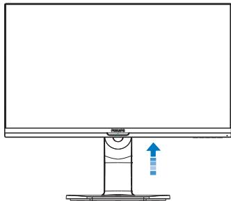
2. Положите монитор экраном вниз на ровную устойчивую поверхность. Будьте внимательны, чтобы не поцарапать и не повредить экран. Поднимите подставку монитора.
