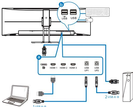
3. Otvorite OSD izbornik. Odaberite KVM sloj te odaberite, "USB up1" ili "USB up2" za prebacivanje kontrole perifernih uređaja između sustava. Jednostavno ponovite taj korak kako biste odabrali upravljanje drugim kontrolnim sustavom putem kompleta perifernih uređaja.
