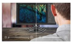
Монитор PowerSensor оснащен "датчиком присутствия", который излучает и улавливает безопасные для человека инфракрасные импульсы, определяет присутствие пользователя и автоматически уменьшает яркость монитора, если пользователь не находится рядом. Эта технология позволяет снизить энергопотребление на 80 % и значительно увеличить срок службы монитора
