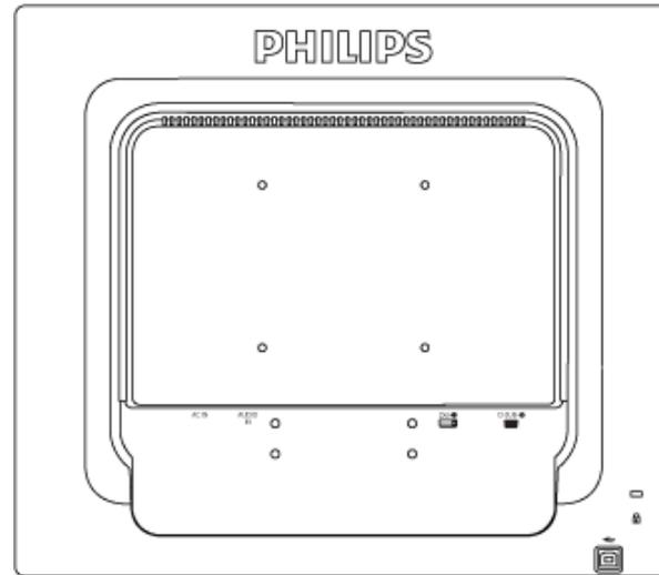
**Nota:** Il monitor è predisposto per un'interfaccia di montaggio 100 mm x 100 mm, conforme a VESA.
