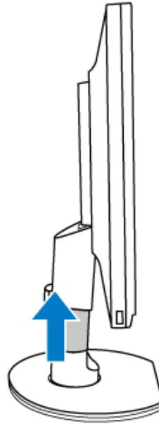
**(b)** Posizionare il monitor capovolto su una superficie senza asperità, facendo attenzione ad evitare di danneggiare lo schermo. Quindi, sollevare la base del monitor.
