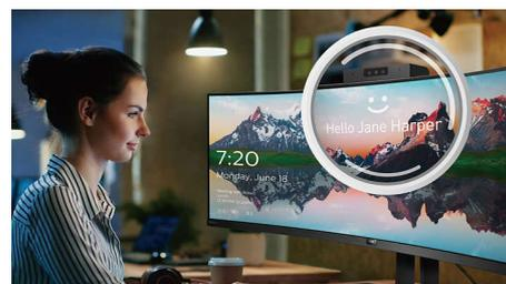
L'innovativa e sicura webcam Philips compare quando ne hai bisogno e si ripositiona all'interno del monitor quando non è in uso. La webcam è inoltre dotata di sensori avanzati per il riconoscimento facciale tramite Windows Hello™, che consente di autenticarsi ai propri dispositivi Windows in meno di 2 secondi, 3
