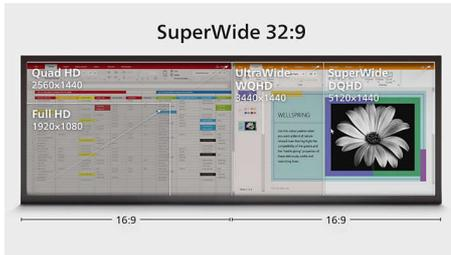
Schermo Superwide da 49" in 32:9 con risoluzione 5120 X 1440, progettato per sostituire le impostazioni multischermo per un'esperienza visiva ampia e completa. È come avere due display Quad HD da 27" in 16:9 affiancati. I monitor Superwide offrono l'area di visualizzazione di due monitor senza necessità di configurazioni complicate.
