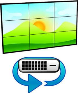
使用 DVI 菊花链创建 15 x 10 多达 150 块显示屏的视频墙。只需将 DVI 输出端口连接至另一显示屏的 DVI 输入端口，即可创造最令人惊叹的视频墙体验。
