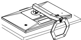
2. Medtem, ko držite gumb za sprostitev pritisnjén, naklonite podnožje in za izvlecite navzven.
