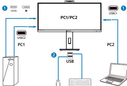
3. Accédez au menu OSD. Accédez à la section KVM et sélectionnez "Auto", "USB C1" ou "USB C2" pour basculer le contrôle des périphériques d'un appareil à l'autre. Répétez simplement cette étape pour commuter le système de contrôle à l'aide d'un seul ensemble de périphériques.
