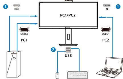
3. Accédez au menu OSD. Accédez à la section KVM et sélectionnez "Auto", "USB C1" ou "USB C2" pour basculer le contrôle des périphériques d'un appareil à l'autre. Répétez simplement cette étape pour commuter le système de contrôle à l'aide d'un seul ensemble de périphériques.
