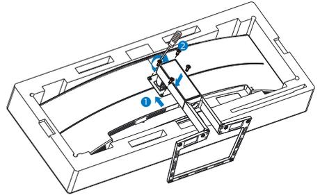
3. 安装底座后，用双手抓住与塑料泡沫紧扣在一起的显示器，使显示器直立。现在可以拔出泡沫塑料了。注意本显示器采用弯曲设计，拔出泡沫塑料时，不要挤压面板以避免损坏面板。
