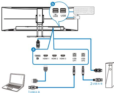
3. 进入OSD菜单。进入KVM层，通过选择“USB up1”或“USB up2”将外设的控制从一台设备切换到另一台设备。重复此步骤即可通过使用一组外设来切换控制系统。
