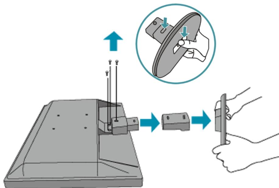
**Nota:** Il monitor è predisposto per un'interfaccia di montaggio 100 mm x 100 mm, conforme a VESA.
