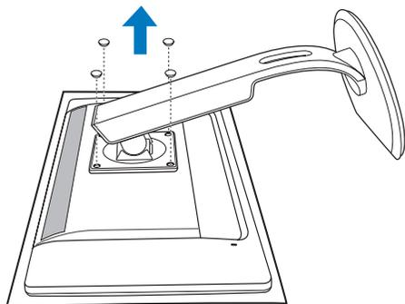
2. Lösen Sie die 4 Schrauben, nehmen Sie die Basis anschließend vom Monitor ab.
