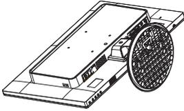
2. Pressione as patilhas de bloqueio para retirar a base da coluna de suporte.
