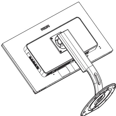
2. Løsne monteringskruene, og ta nakken av skjermen.
