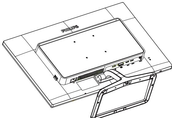
2. Χρησιμοποιήστε τα δάχτυλά σας για να χαλαρώσετε τη βίδα που βρίσκεται στο κάτω μέρος της βάσης και κατόπιν αφαιρέστε τη βάση από το στήριγμα.
