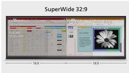
Le moniteur 32:9 SuperWide de 49" (124 cm) avec une résolution de 5 120 x 1 440 est conçu pour remplacer les configurations multi-écrans et offrir un affichage ultra-large. Il correspond à deux moniteurs Quad HD 16:9 de 27" (68 cm) installés côte à côte. Les moniteurs SuperWide présentent la même surface d'affichage que deux moniteurs, mais évitent une configuration compliquée.
