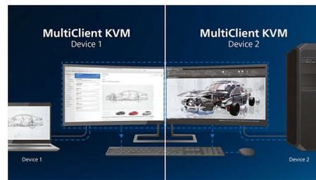
Grâce au commutateur KVM multient intégré, vous pouvez contrôler deux PC distincts avec un seul système moniteur-clavier-souris (KVM). Un bouton commode vous permet de basculer rapidement entre les sources. Pratique pour les installations nécessitant la puissance de calcul de deux PC ou lorsque vous souhaitez utiliser un seul grand moniteur pour afficher le contenu de deux PC différents.
