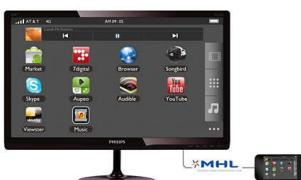
Mobile High Definition Link (MHL) е мобилен аудио/видео интерфейс за директно свързване на мобилни телефони и други портативни устройства към дисплеи с висока разделителна способност.
