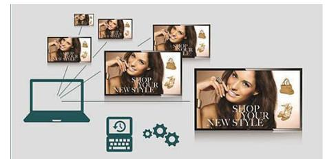
O SmartControl permite que você controle remotamente e gerencie sua rede de monitores usando RJ45 e RS232C. Ajuste facilmente todas as configurações de resolução, brilho, contraste e clonagem de suas configurações em toda a sua rede.
