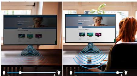
PowerSensor ist ein integrierter Sensor, der durch das Aussenden und Empfangen unbedenklicher Infrarotsignale erkennt, ob sich der Benutzer in der Nähe des Geräts aufhält, und automatisch die Bildschirmhelligkeit reduziert, wenn der Benutzer sich vom Schreibtisch entfernt. So wird der Energieverbrauch um bis zu 70 % gesenkt und die Monitorlebensdauer verlängert.
