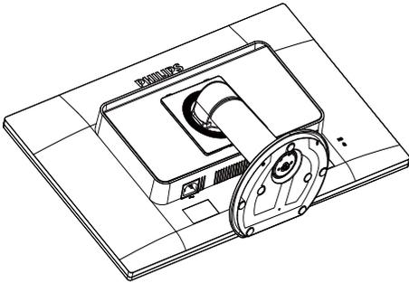
2. Entfernen Sie die Schrauben von der Gelenkabdeckung.
