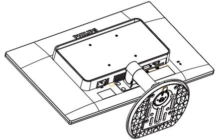
2. Entfernen Sie die vier Mylar-Streifen mit einem Schlitzschraubendreher von der Gelenkabdeckung.
