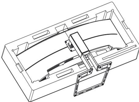
2. Lösen Sie die Montageschrauben, und trennen Sie dann die Halterung vom Monitor.
