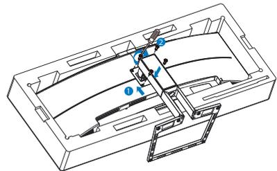
3. Richten Sie den Monitor nach Anbringung der Basis auf, indem Sie ihn mit beiden Händen sicher gemeinsam mit dem Styropor greifen. Nun können Sie das Styropor herausziehen. Beachten Sie, dass dieser Monitor ein gewölbtes Design besitzt. Drücken Sie den Bildschirm beim
