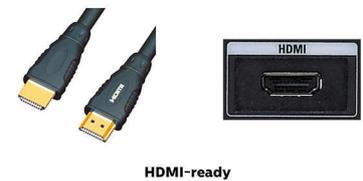
Un dispositivo HDMI-Ready dispone di tutto l'hardware necessario per accogliere un ingresso High-Definition Multimedia Interface (HDMI). Un cavo HDMI consente segnali audio e video digitali di alta qualità trasmessi su un singolo cavo da un PC o un qualsiasi numero di sorgenti AV (tra cui decoder, lettori DVD, ricevitori A/V e videocamere).
