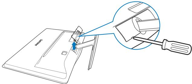
2. Открутите 4 винта и снимите подставку с монитора.
