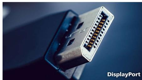
DisplayPort es una conexión digital del PC al monitor sin ninguna conversión. Con mayores capacidades que el estándar DVI, es totalmente capaz de soportar hasta 15 metros de cables y una transferencia de 10,8 Gbps por segundo. Con este alto rendimiento y sin retraso, consigues las imágenes y las frecuencias de
