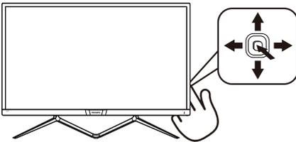
1. Deslice el botón de encendido hacia la izquierda para iniciar el menú de visualización en pantalla de SmartImage.
