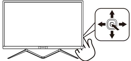
Para acceder al menú OSD de esta pantalla Philips simplemente tiene que utilizar el botón de cambio único situado en la parte inferior del marco de la pantalla. El botón único opera como un joystick. Para mover el cursor, simplemente accione el botón en cuatro direcciones. Presione el botón para seleccionar la opción que desee.
