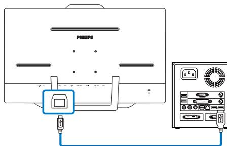
1. Подключите USB-кабель от ПК к USB-разъему типа B на нижней панели входа/выхода монитора.
