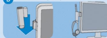
Após a instalação do suporte para a caneta, pode utilizá-lo para segurar numa caneta ou para segurar auscultadores.
