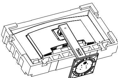
2. Нажав кнопку фиксатора, наклоните стойку и извлеките его.
