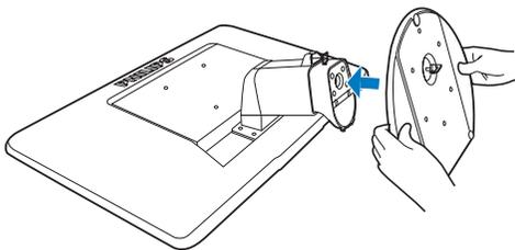
3. Coloque a base do monitor na coluna e depois aperte-a.
