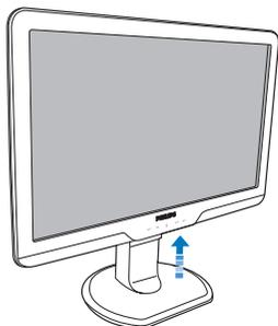
2. Coloque o monitor com o ecrã virado para baixo sobre uma superfície macia evitando riscar ou danificar o ecrã. Em seguida, levante a base do monitor:
