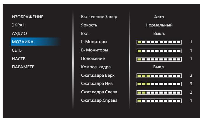
Благодаря данной функции, можно создавать единую широкоэкранную матрицу (видеостену), состоящую из 150 мониторов (до 10 мониторов по вертикали и 15 мониторов по горизонтали). Для выполнения данной функции необходимо соединение "цепочкой".
