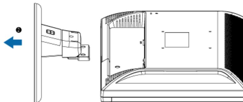
**Observación:** Este monitor admite sistemas de montaje VESA de 100 x 100 mm.
