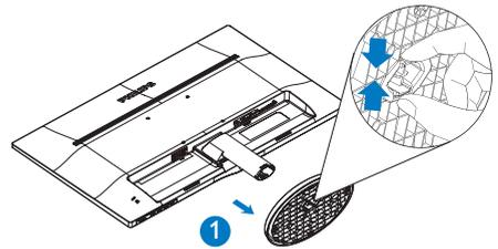
3. Pritisnite taster za otpuštanje da odvojite stub baze.
