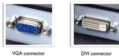
Двойной вход обеспечивает разъемы для входа как по аналоговому VGA, так и по цифровому DVI сигналам.
