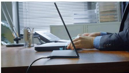
Il piedistallo ad inclinazione continua può essere inclinato da 0 a 90 gradi con una flessibilità che consente di ottenere il massimo comfort ovunque sia necessario stare al passo con il lavoro.
