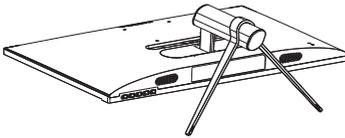
2. Rimuovere il copricerniera dal corpo del monitor utilizzando lo strumento ausiliario.
