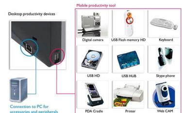
通用序列匯流排，或簡稱 USB，是連接電腦與週邊的標準協定。因為其高速、低成本的特性，USB 已成為連接電腦週邊最熱門的方式。使用者視線中的顯示器直接提供連接埠，是最方便、最輕鬆連接高速 USB 裝置的方式（是否支援 USB 2.0 要視每台電腦的 USB 組態而定；連接至支援 USB 2.0 的電腦時，您的顯示器便兼容 USB 2.0）。
